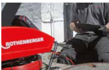
App ROTHENBERGER, permite monitorizar el proceso, ajustar parámetros y generar informe
