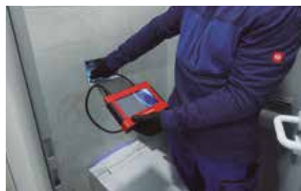
Módulo TEC indicado para la inspección de espacios huecos y áreas de difícil acceso.
