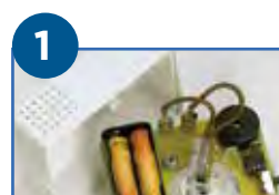
1 Inserir 2 pilhas de 1,5 V (não incluídas) na caixa.
