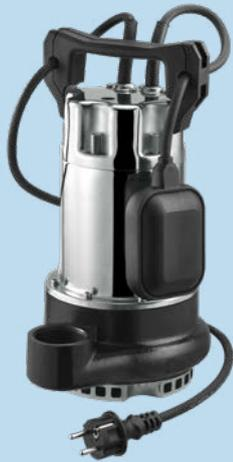
Bombas de drenagem com impulsor aberto para bombagem de líquidos com sólidos em suspensão. Caracterizado por cabeça alta. A versão monofásica inclui condensador incorporado, protetor térmico e pode ser equipada com boia.
