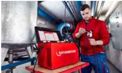
El uso de pasta conductora de calor garantiza una congelación óptima
