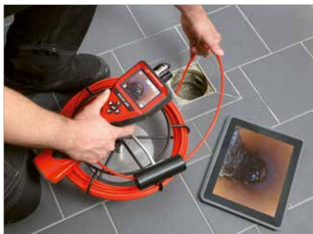
Inspección de drenajes de baños
