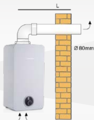
Ventilado A longitude máxima depende do modelo do aparelho e da configuração do tubo de evacuação. É recomendado que se verifique os manuais de instalação.
