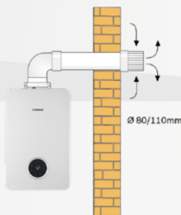
Estanques O tipo de instalação depende da utilização de uma chaminé concêntrica ou independente. Recomenda-se verificar os manuais de instalação.
